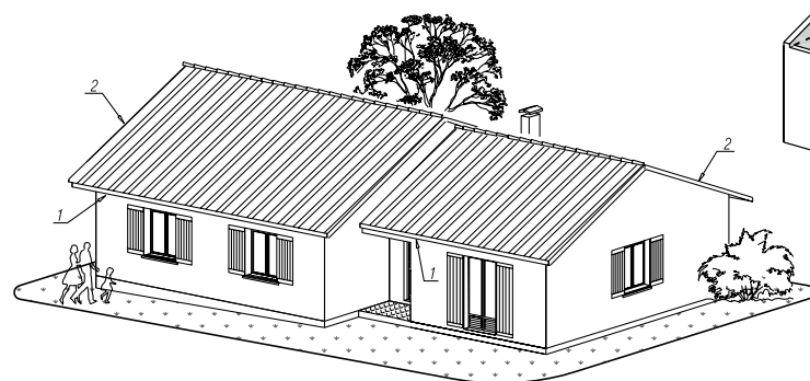
Fig. 25 Perspective avec un toit à deux pentes 1. rive d'égout, 2. rive latérale
